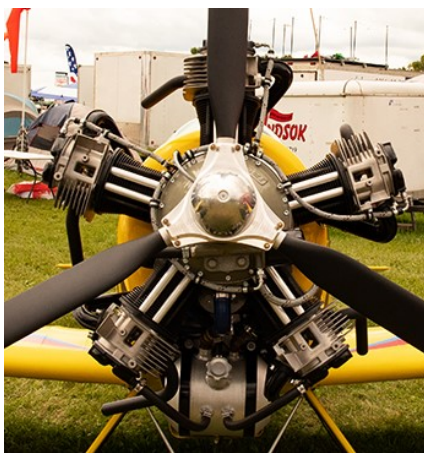
FIGURE 1.1 – Moteur à 5 cylindres en étoile : Verner Scarlett 5S.
