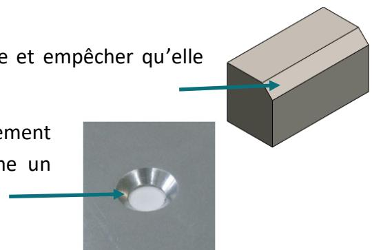
Etant un élément courant, la norme spécifie clairement comment les coter : il faut donner l'angle et la longueur dans l'axe d'une des autres faces. Autrement dit, en imaginant que le chanfrein forme un triangle rectangle, c'est la longueur d'un des cotés et non l'hypoténuse.
